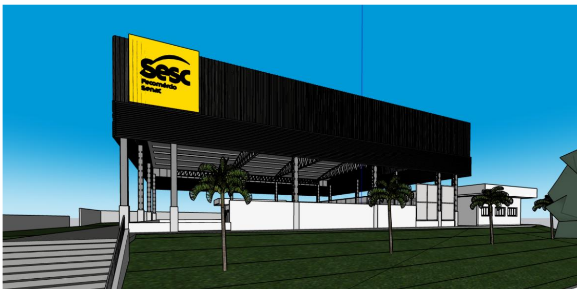
Figura 03 – Fechamento com brise e telha da ISOESTE cor preto em ambos os lados.
